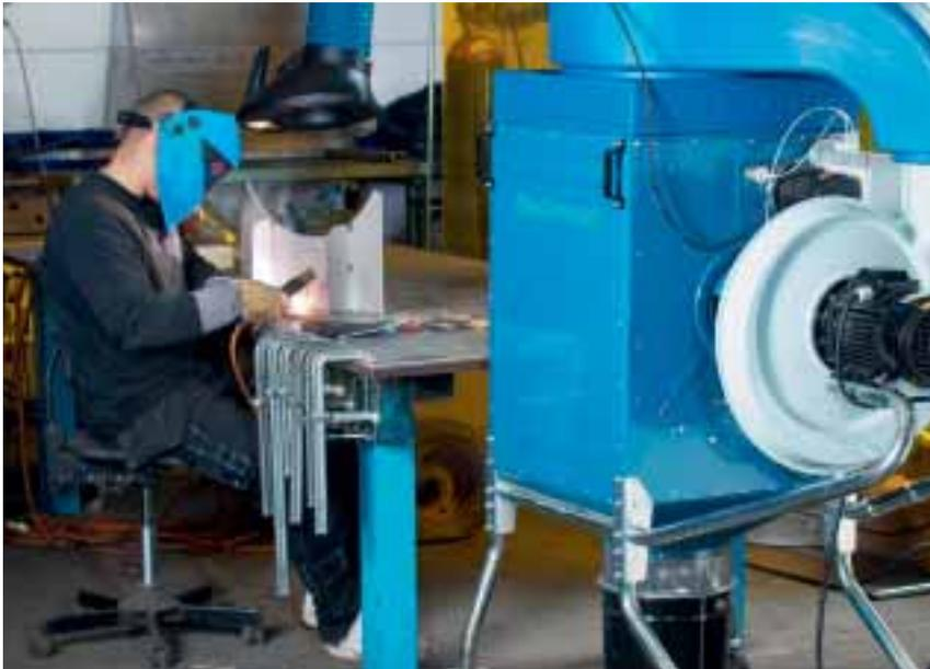
Mobile FilterBox Einheit komplett mit Original-Absaugarm.
