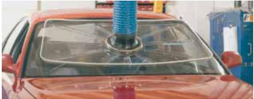
Der Windschutzscheiben-Absaugarm von Nederman basiert auf dem Original-Arm wurde speziell für das Absaugen von Klebstoffdämpfen entwickelt, wie sie beim Ausbau oder Einbau von Windschutzscheiben entstehen. Der Arm ist in einer Länge von 4 m erhältlich und hat eine rechteckige Absaughaube mit einer verlängerten Öffnung entlang der Kante, die der Absaugung von Dämpfen beim Einkleben der Windschutzscheibe dient.
