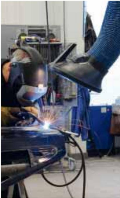
Der Arm wurde speziell für Arbeitsumgebungen mit Rauch und Dämpfen bei nicht explosiver Atmosphäre entwickelt. Typische Arbeitsplätze sind Metallwerkstätten oder andere Industriebereiche, in denen eine Absaugung erforderlich ist. Die Arme können bei Schweiß-, Schleif- und anderen industriellen Prozessen eingesetzt werden, bei denen ein einfach zu positionierender Arm benötigt wird. Der Arm ist in Längen von 2 bis 4 m erhältlich und mit einer hochwirksamen Absaughaube ausgestattet.
