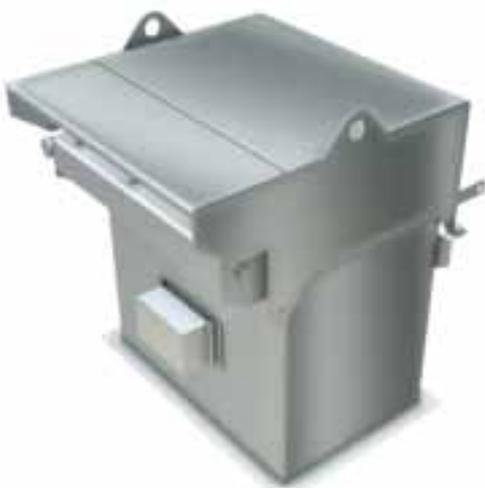
Ein Patronenfilter mit Druckluftabreinigung und einer Filterfläche von 24 m² zur Belüftung von Silos. Auch mit einem 2,2 kW Ventilator lieferbar (SiloSafe 24F). Starke Schweißkonstruktion aus 4 mm feuerverzinktem Stahlblech. Filter können problemlos ausgetauscht werden. Hierzu wird lediglich der Deckel nach oben aufgeklappt und die Patronen werden von oben gewechselt. Der Filter ist in ATEX-Versionen St1 bis St3 lieferbar.
