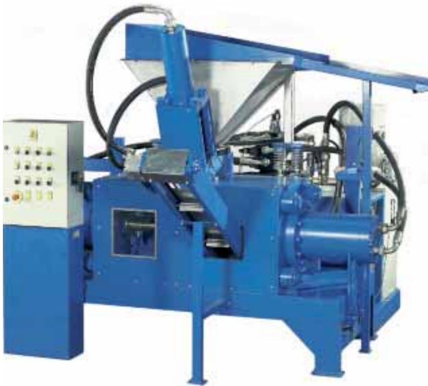
**Eine Brikettierpresse reduziert den Kühlschmiermittelverlust und das Materialvolumen und spart so Handhabungs- und Transportkosten.**
