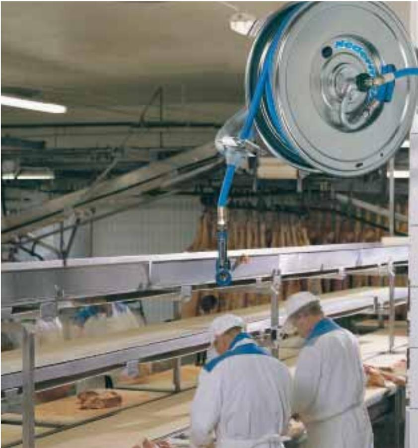
Dieser Schlauchaufroller, der komplett aus Edelstahl besteht, wurde speziell für die lebensmittelverarbeitende Industrie und deren anspruchsvollen Anforderungen an die Hygiene konzipiert. Dank abgerundeter Kanten, an denen sich keine Bakterien ansammeln können, ist er sehr einfach zu reinigen. Der Schlauchauslauf und das extern montierte Drehgelenk können mühelos abmontiert und separat gereinigt werden.
