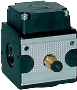
Eine plötzliche Druckluftzufuhr kann für eine Pumpe zu einer extremen Belastung des Gehäusematerials und der Membranen führen. Diese Druckspitzen können durch langsame und stufenweise Erhöhung des Betriebsdrucks ausgeglichen werden. Um diesen Prozess zu automatisieren, haben wir ein Langsam-Anfahrventil für alle DEPA®-Pumpen entwickelt.
