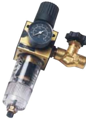
Der Spezialfilter der DEPA® Druckluftwartungseinheiten reinigt die Druckluft durch Entfernung aller Wasser- und Ölreste. Der eingebaute Druckminderer hält den Arbeitsdruck konstant und verhindert Druckschwankungen aus der Hauptdruckluftversorgung.
