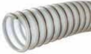
Robuster Schlauch, glatte Innenfläche. Geeignet für die Beförderung scheuernder Materialien wie Sandstrahlmitteln, Metallspänen und Glasfaserstaub. Sehr gute Verschleiß- und Alterungsbeständigkeit. Widerstandsfähig gegen Kraftstoffe, Öle, Lösungsmittel und Fette.
